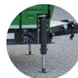
Béquilles hydrauliques à l'avant et à l'arrière
