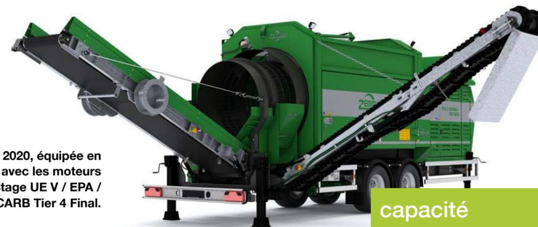
capacité de criblage de 150 m<sup>3</sup>/h
