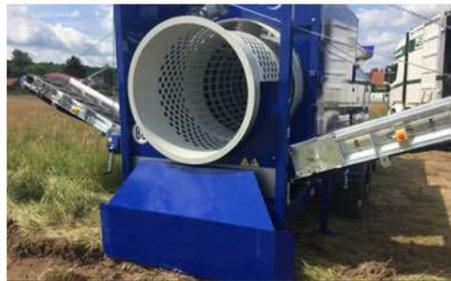
PEINTURE SPÉCIALE ET TÔLE DÉFLECTRICE 3<sup>ème</sup> FRACTION
