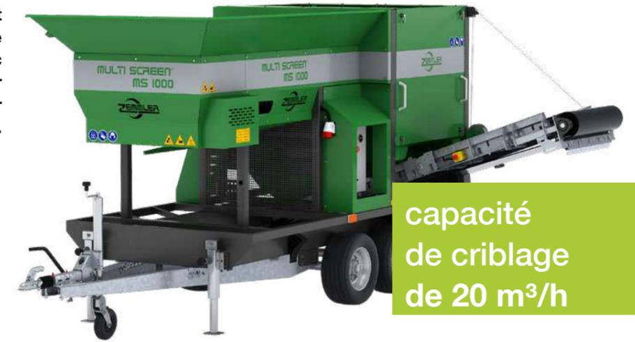
capacité de criblage de 20 m³/h
